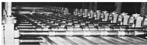
Gambar 1. Proses pembentuk profil baja (Yu,2000)
